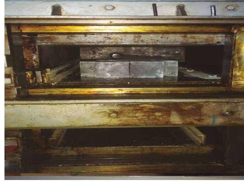
Figura 5. construção do castelinho de chumbo
